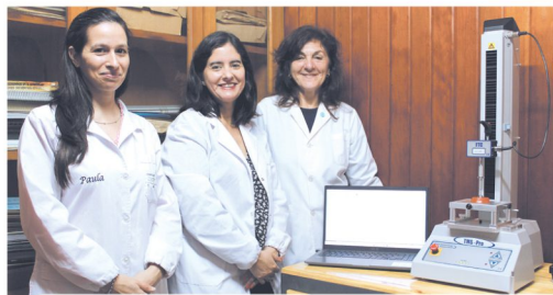
MAYOR CALIDAD El texturómetro permite analizar la untuosidad de una mermelada, la dureza de un trozo de fruta, entre otras cualidades.
