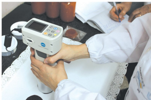
COLORÍMETRO Esta herramienta brinda datos sobre la composición del color de cada producto y ayuda a ajustar la fórmula de elaboración.
